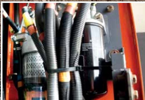
Der Kraftstoffhauptfilter lässt sich einfacher auswechseln.
