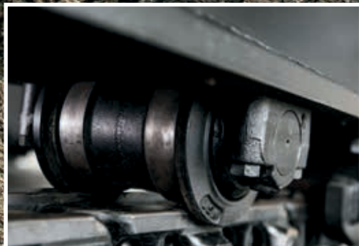
Neu konstruierte Laufrollen verhindern das Eindringen von Schlamm und Beschädigungen.
