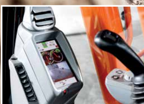
Der LCD-Monitor zeigt den Status und die Einstellungen der Maschine.
