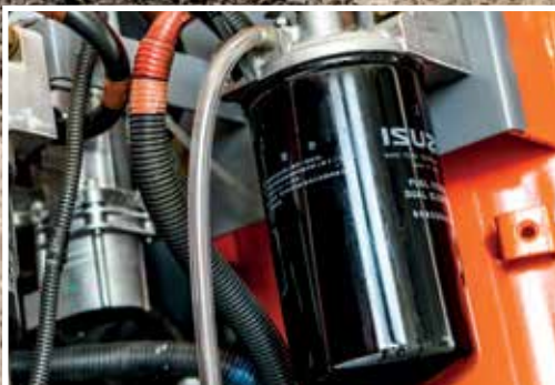
Der Kraftstoffhauptfilter lässt sich einfacher auswechseln.
