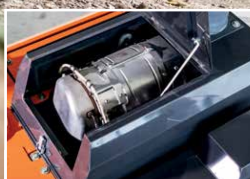
Das SCR-System reduziert Emissionen und Geräusche.
